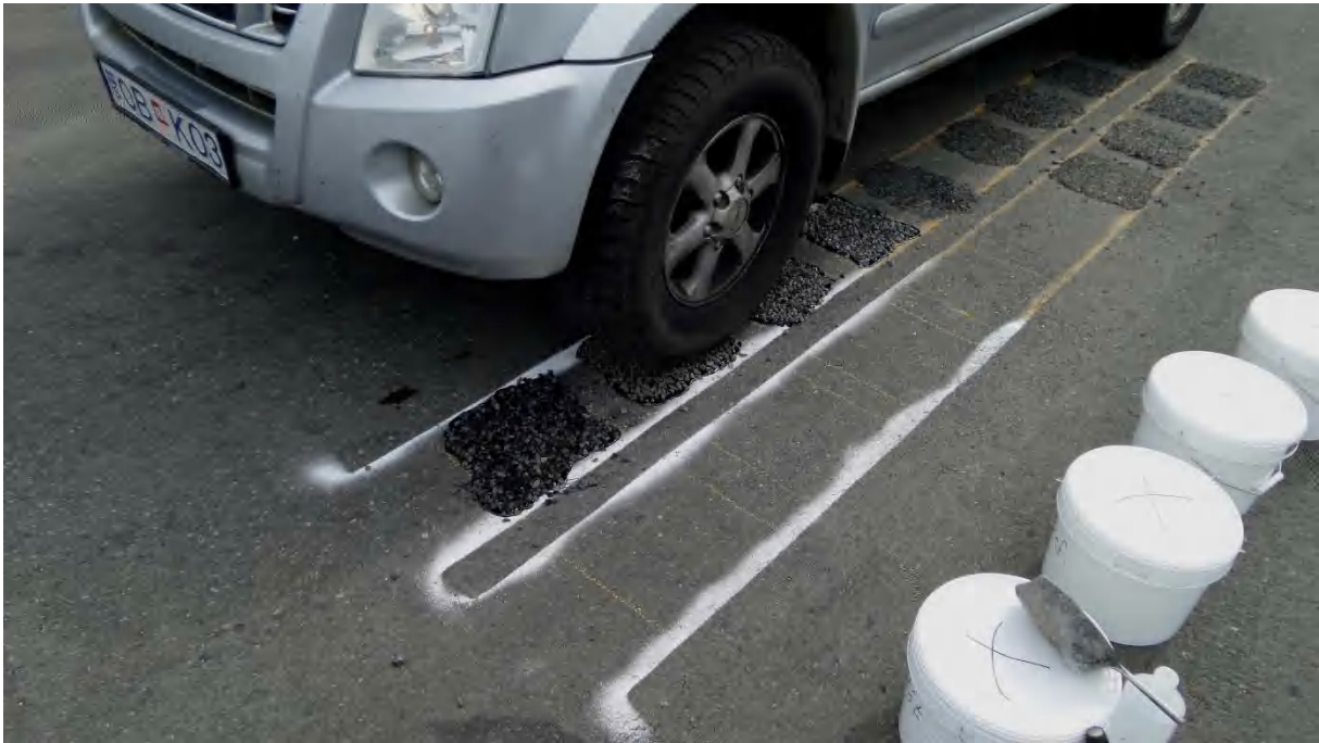
Mynd 6 Steinefni þjappað með dekki sem ók fram og til baka nokkrum sinnum
