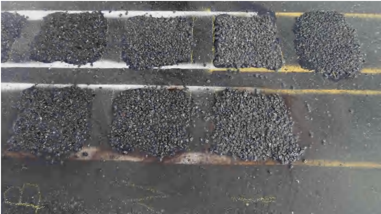
Mynd 8 Brúnn vökvi rennur úr reitunum sem voru lagðir síðar (nær á myndinni)
